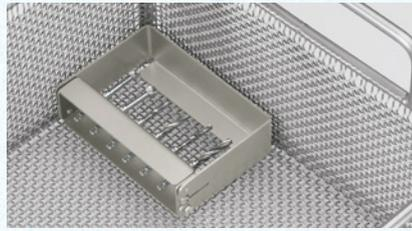
Abb. 1 Platzierung des Instrumentenständers in das RDG.
