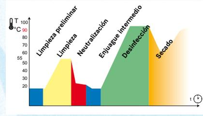
**Fig. 2** Ejecución de programa esquemático del programa Vario TD
